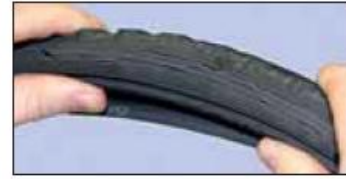
Crepe dovute alle sollecitazioni eccessive
