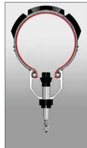
Sistema Tubeless: tenuta stagna tra pneumatico e cerchio.
